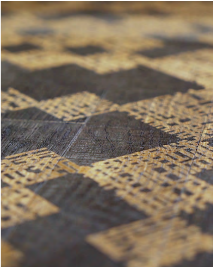
dettaglio della lavorazione laser sulle liste detail of the laser engraving on the wood boards
